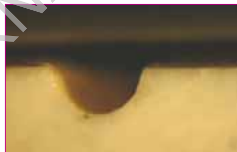
Fig. 2 - Tacca del gruppo S a maggior ingrandimento. In particolare si nota l'irregolarità del bordo esterno (chip).
